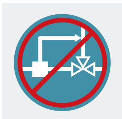
Bypass nicht zulässig
